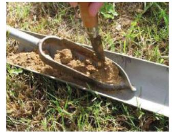
**G.** Déposer de nouveau la carotte dans la gouttière. Le dépôt est effectué suite à la mesure dans le trou de la profondeur du sondage. Il est préconisé de mesurer directement dans le trou à l'aide d'un mètre ruban afin de positionner correctement le prélèvement dans la gouttière.
