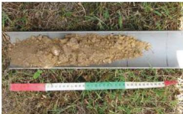
**H.** Répéter les opérations A à C puis F à G jusqu'à ce qu'on ne puisse plus creuser (roche atteinte, cailloux empêchant d'avancer, 60 cm atteints). Une fois le sondage réalisé, nous disposons, dans la gouttière, d'une vision d'ensemble du profil reconstitué. Dans le protocole, il est recommandé de creuser jusqu'à 60 cm de fond. Lorsque vous effectuez les premiers sondages sur un site non connu du point de vue pédologique, il est recommandé de le faire plus profond (120 cm).
